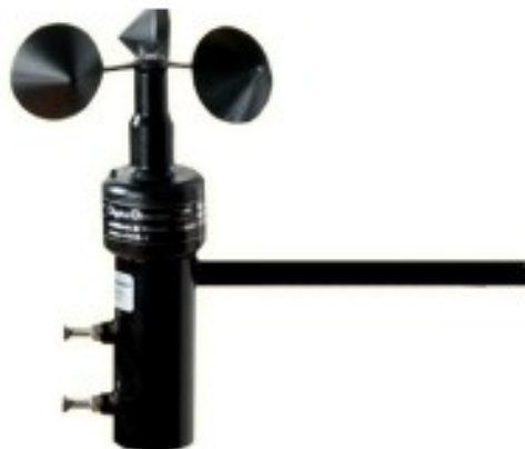
Figura 6. Anemómetro de cazoletas
