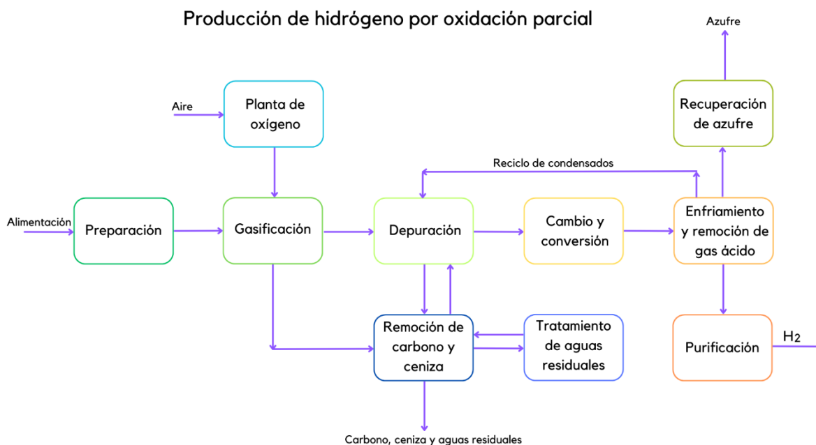
Ilustración 4 Diagrama de producción de hidrógeno por oxidación parcial. Tomado de (Meyers, 2016)
